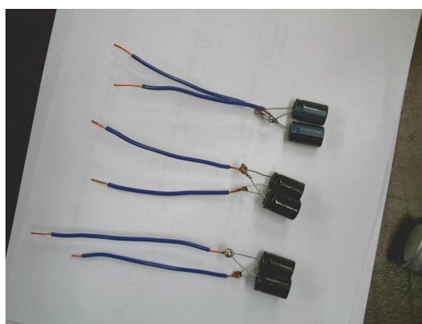
Рис. 6. Процесс пайки батареи конденсаторов
