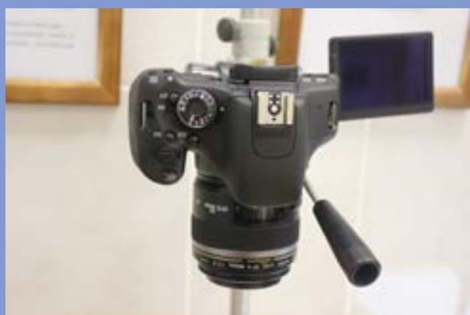
*Фотоаппарат CANON EOS 600D с макрообъективом CANON 60/2.8 EF Macro USM предназначен для фотографирования незначительных по размерам объектов и следов*
