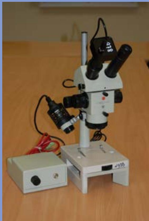
Микроскоп стереоскопический МБС
